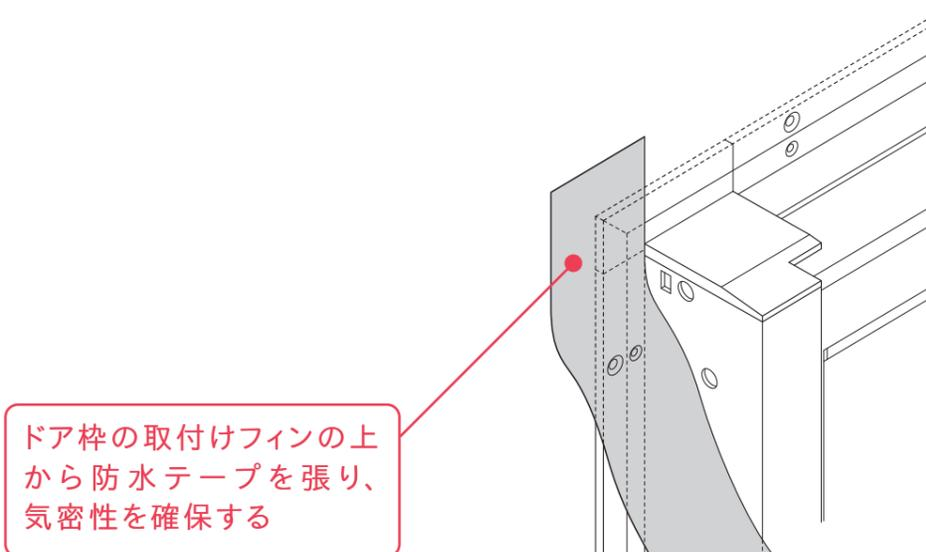
ドア枠の取付けフィンの上から防水テープを張り、気密性を確保する
