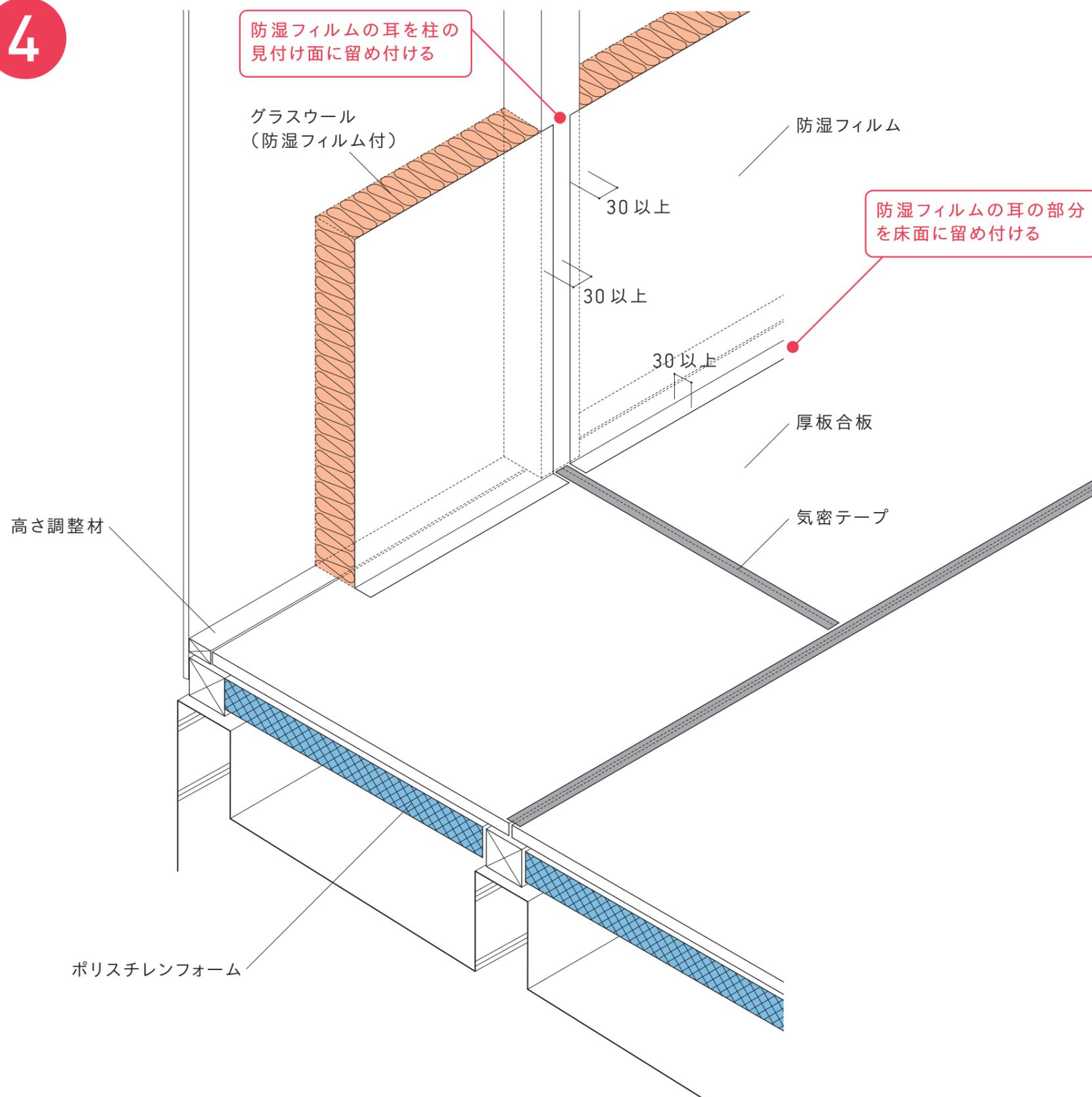
・外周部にグラスウールを充填し、防湿フィルムを柱の見付け面、床面に30mm以上重ねて留め付け、壁から床に連続した防湿層をつくる。
